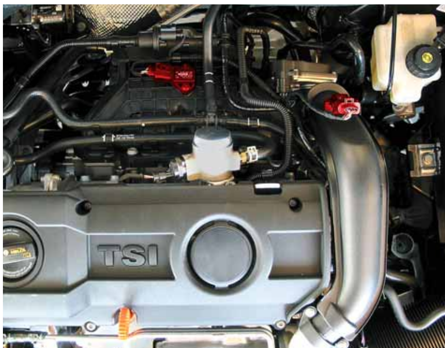
Сенсор давления во впускной трубе (слева) и сенсор давления наддува (справа) в модели VW Golf VI (выделенно красным цветом)
